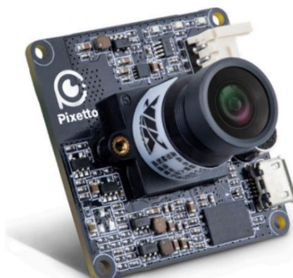
圖 5 Pixetto 鏡頭 示意圖[4]
