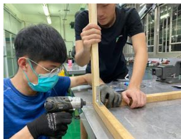
圖 11：使用電鑽鎖緊螺絲
