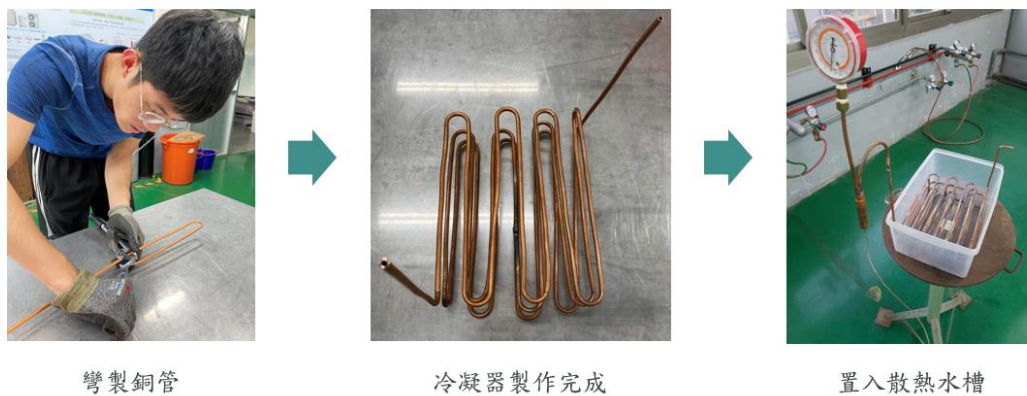
圖 24：冷凝器製作流程圖
