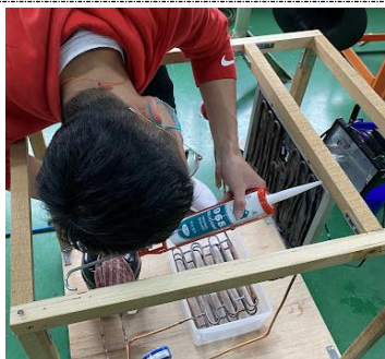
圖 14：使用矽利康加固太陽能板
