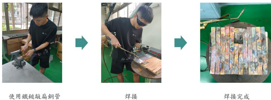
圖 22：散熱銅片製作示意圖
